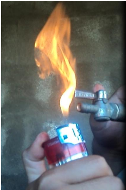
Figura 04- Queima de gás do Biodigestor piloto.
