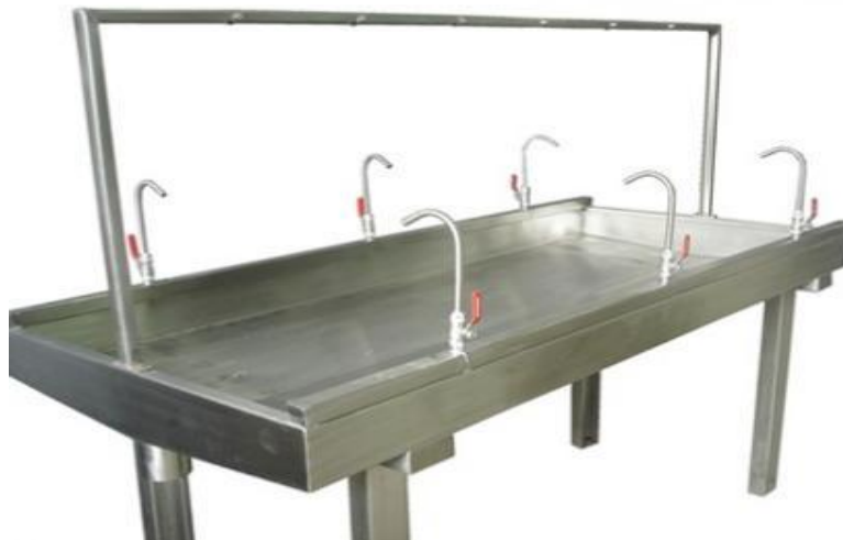
Figura 3 – Mesa de limpeza por Aspersão. Fonte: Arcevo ISPN.
