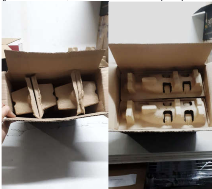
Figura7 - Modelo dois, aberta com o revestimento especial posicionado.
