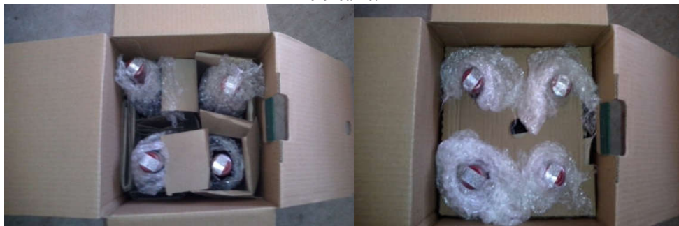
Figura2 - Caixa com capacidade para quatro garrafas montada com garrafas revestidas de plástico bolha, calços e encaixe.
