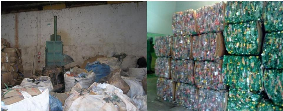
Figura 10: Prensa Hidráulica para garrafas PET Figura 11: Fardos de garrafas PET prontas para o transporte.
