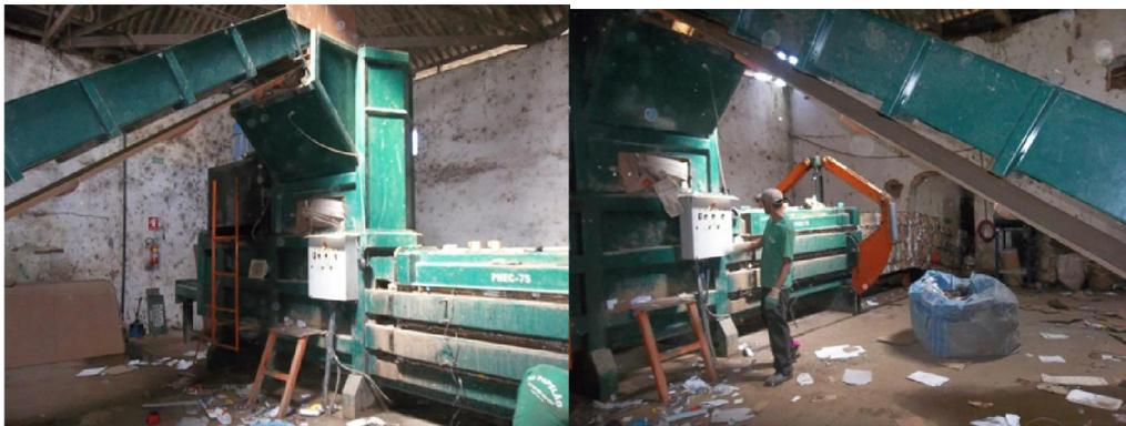
Figura 6: Esteira e prensa para papelões      Figura 7: Esteira com a saída dos fardos de papelões.
