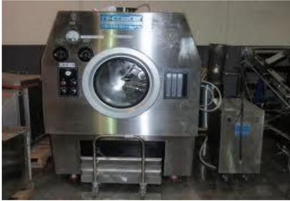
Figura 03: Máquina utilizada para revestir o comprimido e definir sua coloração.
