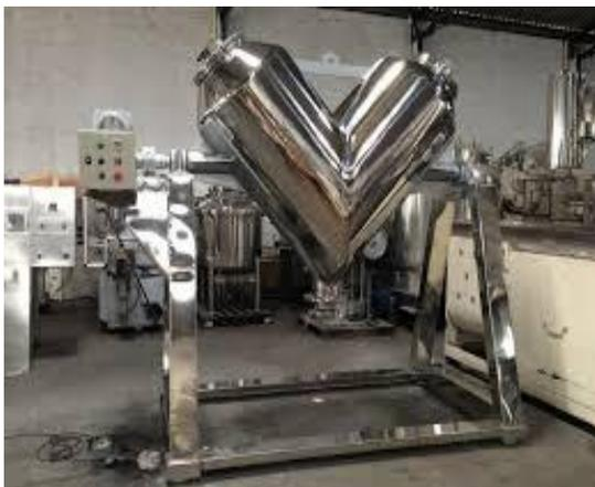
Figura 01: Misturador em “V” durante processo do medicamento, com capacidade para 1200 litros.
