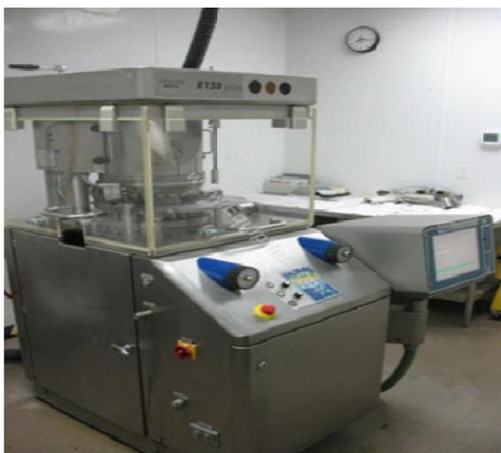
Figura 02: Máquina utilizada para comprimir o medicamento.
