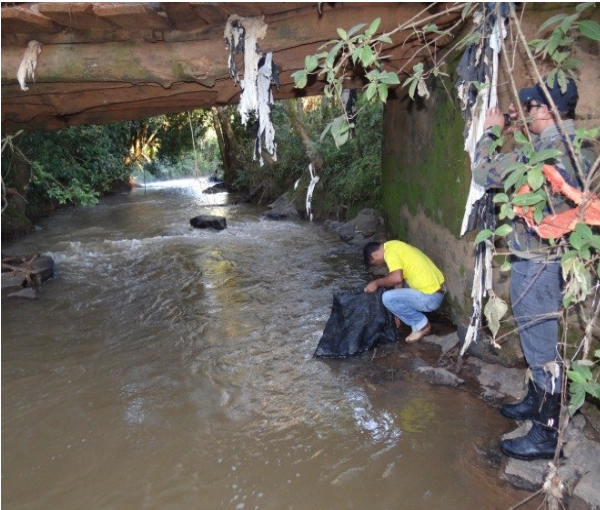
Figura 16 - Coleta de bentônicos com rede “D”
