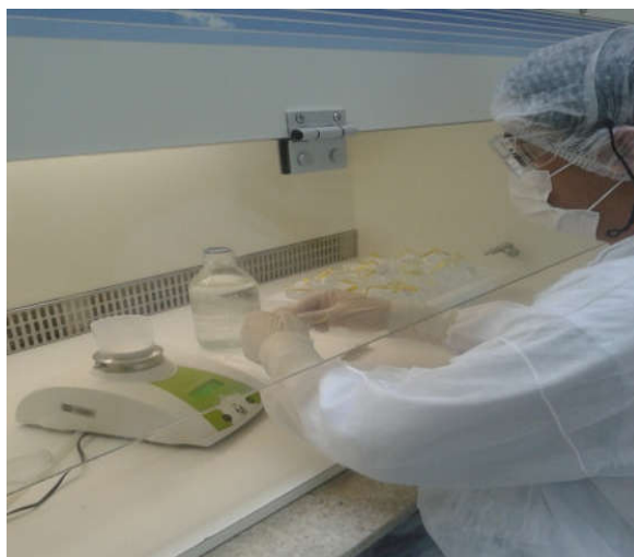
Figura 1 – Método de filtração por membrana utilizado nas análises microbiológicas de água
