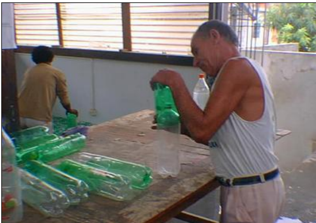
Figura 3. Mostra do encaixe das garrafas pet, realizada na oficina de fabricação do puff
