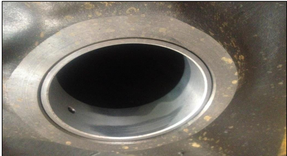
Figura 14 - Bucha do comando com desgaste avançado.
