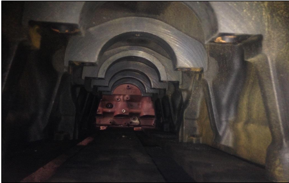
Figura 13 - Mancais internos ausentes de avarias no colo.
