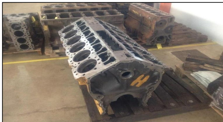
Figura 12 - Bloco do motor desmontado para plainar base do cabeçote e aferição de medidas.
