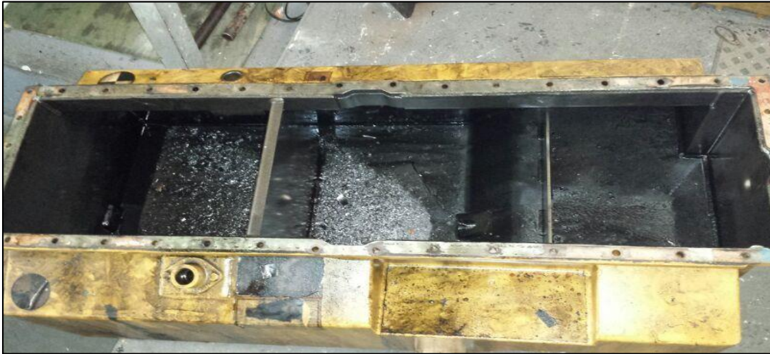
Figura 8 - Remoção do cárter do motor com evidência de desgaste de bronzinas.
